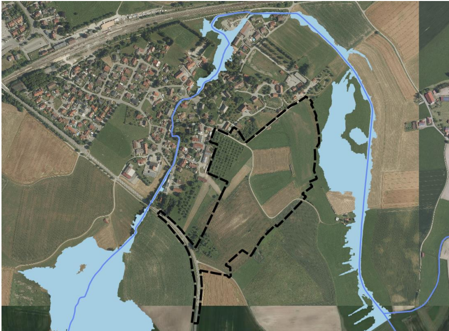
Abb. 8: HQ100-Überschwemmungsflächen entlang des Krebsgrabens
